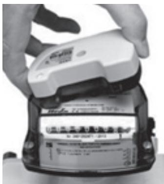
2) Screwing (Max torque: 0,25 Nm)
