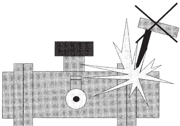
(D) Keine Schweißarbeiten bei dem installiertem Gerät vornehmen.
