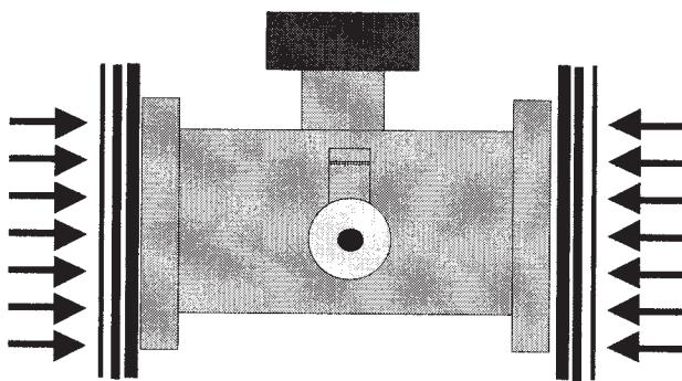
④ Den Zähler spannungsfrei einbauen.
