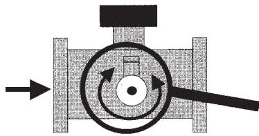
(D) Wenn der Zähler mit einer Ölpumpe versehen ist, bitte der Einbaulage horizontal / vertikal anpassen (horizontal = Standard).
