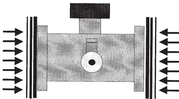
④ Den Zähler spannungsfrei einbauen.
