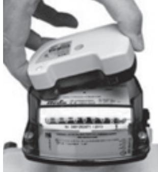
2) Screwing (Max torque: 0,25Nm)
