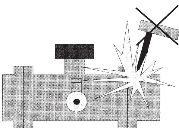
(D) Keine Schweißarbeiten bei installiertem Gerät vornehmen.
